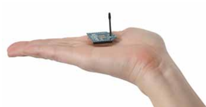
Bild 3: Beispiel für ein Funkmodul zur Vernetzung von Sensoren
